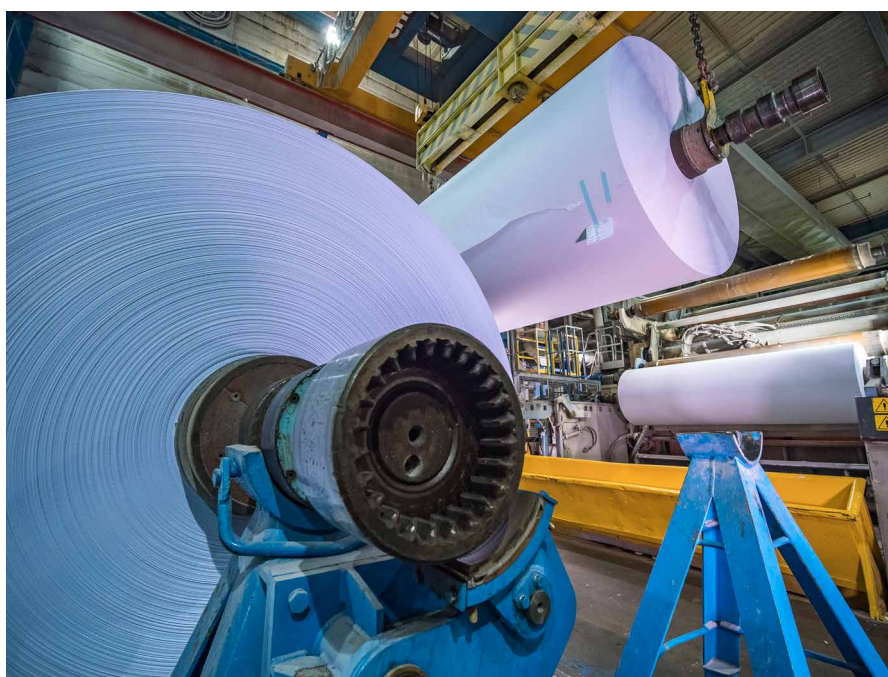
Bobines mères en sortie de machine à papier - Papeteries de Clairefontaine
