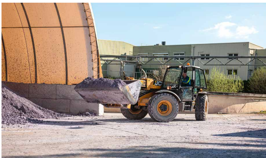
Papeteries de Clairefontaine – Manutention des boues d'épuration
